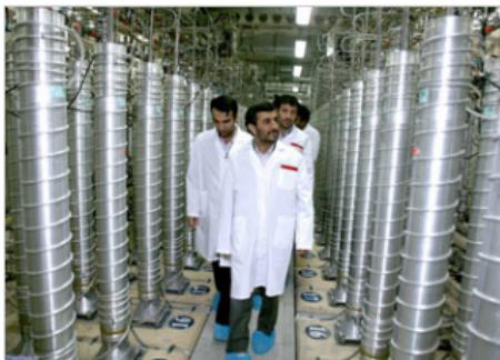
Separation av U-235 och U-238:  $\approx 100000$  varv/minut för centrifuger
